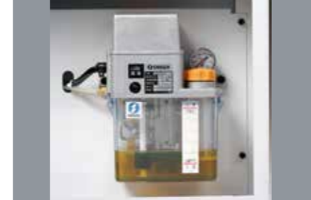
自動潤滑油装置 / Automatic lubrication unit
