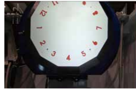
自動工具交換装置 12本 / 14本 (オプション) Automatic tool changer 12 tools / 14 tools (Option)
